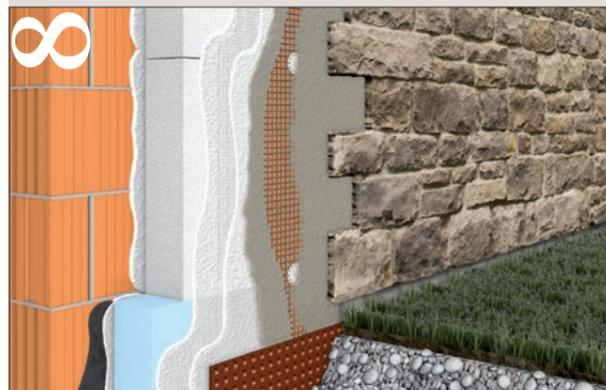
*murogeopietra: pose sur système d'isolation thermique par l'extérieur.*
