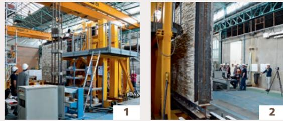
1. Installation du mur sur la machine pour la simulation
